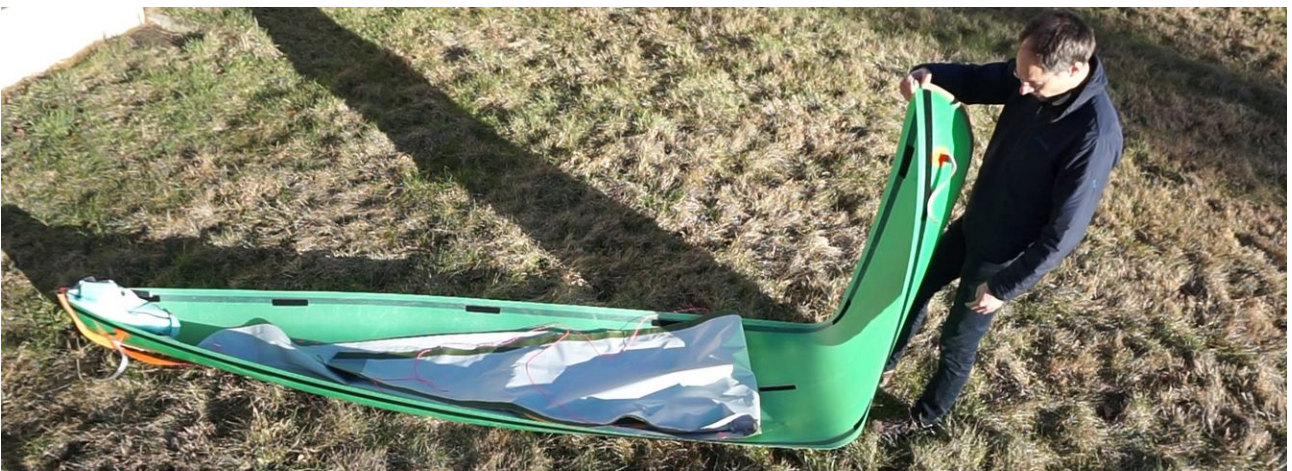
Bild 6: Aufrollvorgang der Bootshaut, Aufstellen der Bootshaut am Bug
