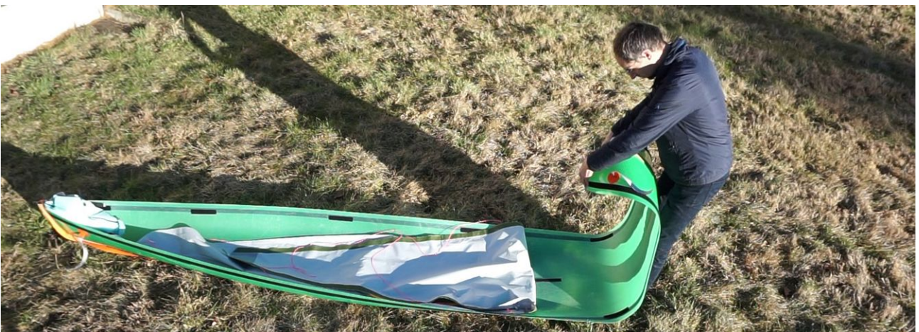
Bild 7: Bootshaut wird an den Beinen abgestützt und die Bootshaut am Bug eingerollt
